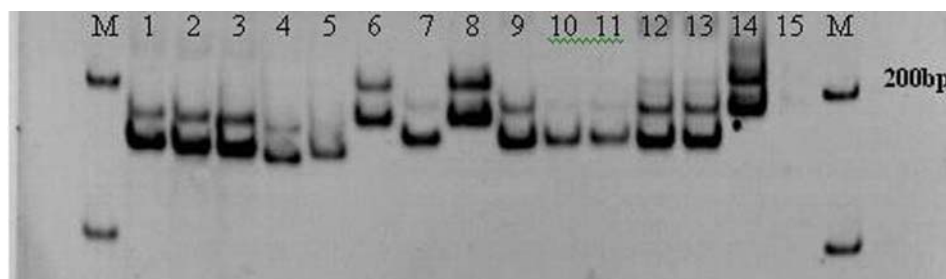
شکل ۲- نمونه ژل پلی اکریل آمید ۶ درصد با استفاده از نشانگر QAAT074 نمونه‌ها به ترتیب از ۱ تا ۱۴ مربوط به مورفوتیپ‌های 881014، 881013، 881022، 881031، 881032، 881041، 881043، 881056 و 881057، شماره ۱۵ کنترل منفی و M نشانگر وزنی در ابتدا و انتهای ژل بودند.
